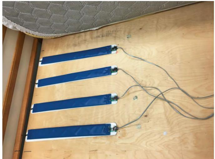
Fig. 1. The hydraulic bedsensor.
